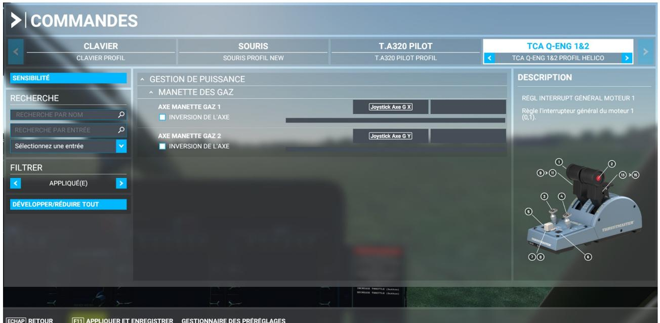
Pour l'axe manette Gaz 1 choisissez Joystick Axe G X et pour l'axe manette Gaz 2 choisissez Joystick Axe G Y. Allez ensuite régler les paramètres de sensibilité selon le tableau suivant :
