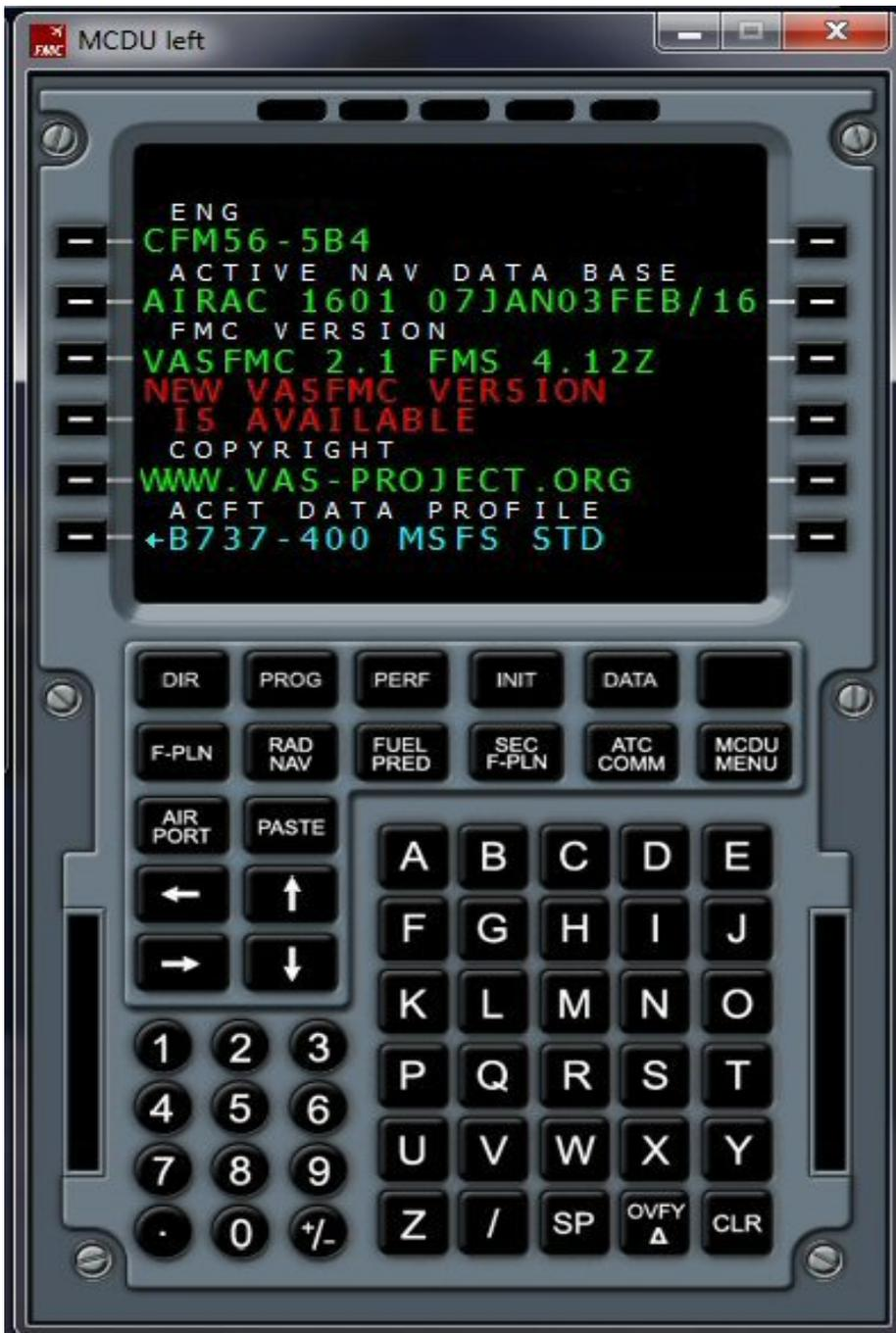
Et l'instrument le plus important, le FMS ou "Flight Management System" qui est composé du Flight Management and Guidance Computer (FMGC ou FMC...) et de l'écran, le Multifonction Control and Display (MCDU). Donc en fait, la face visible de l'appareil que l'on voit ici est le MCDU.
