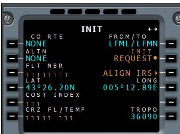
Il apparaît LFML/LFMN. Il faut alors tout de suite cliquer sur le bouton en regard du texte écrit en orange ALIGN IRS... Cela sert à simuler les alignement des centrales d'inertie de votre appareil.
