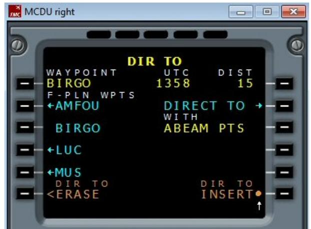
Une liaison en pointillés jaunes apparaît sur le plan de vol. Il suffit de confirmer le tracé en cliquant sur le bouton en regard de INSERT.
