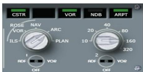
La partie suivante de l'EFIS permet de contrôler l'affichage du Navigation Display. Nous avons vu en grande partie ses fonctionnalités.
