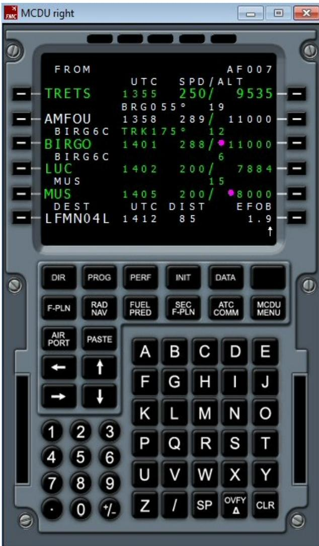
Rien de plus simple, on va sur le MCDU et on clique sur DIR.
