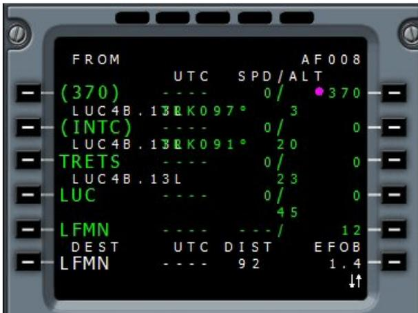
Voilà, la SID LUC4B est dans le plan de vol. Si vous jetez un œil sur le Navigation Display, vous pouvez voir que l'on part de LFML pour aller sur TRETJ puis sur LUC. Le trajet n'est plus en pointillés jaunes...
