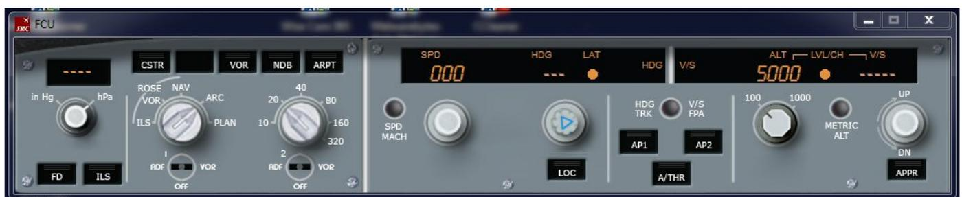
Le FCU (ou Flight Control Unit) qui va gérer la pression, l'affichage du Navigation Display et le pilote automatique...
