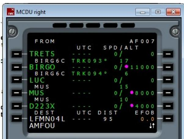
On saisit AMFOU au clavier puis on clique sur le bouton en regard de BIRGO. Cela a pour effet d'introduire le point AMFOU avant BIRGO dans le listing et sur le trajet du Navigation Display.
