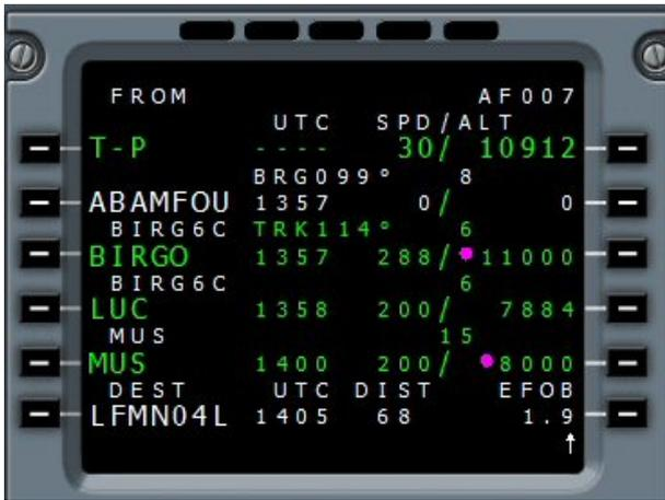
Il apparaît le point ABAMFOU dans le plan de vol et sur le tracé.
